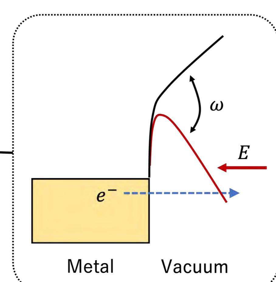
高強度な光電場を用いると、アト秒スケール（1京分の1秒）での電子制御が可能です。私たちは、金属ナノ構造の示すプラズモン電場増強効果とアト秒スケールの電子制御を用いて、100 THz以上の光周波数に追いつく光電場検出器を開発しています。
